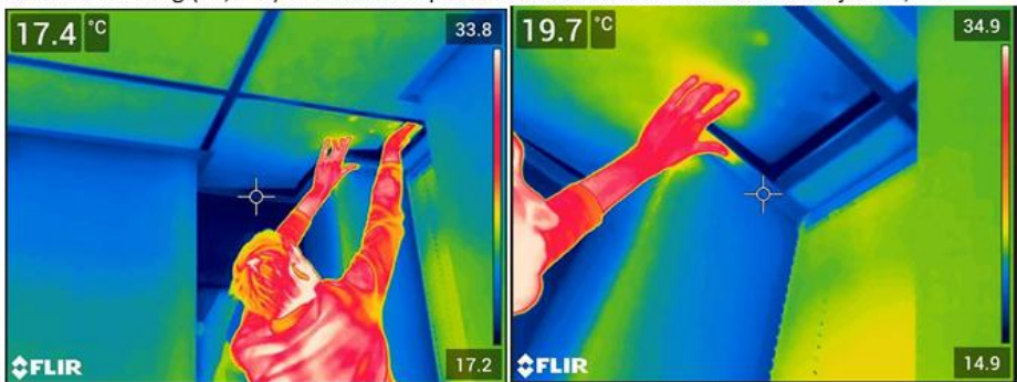
IR foto links, Jarvi Jansen verwijdert plafondtegels, boven smal raam op blz. 2. Daar wordt een luchttemperatuur gemeten van 17,2 °C. Foto rechts opname temperatuur boven plafondplaat 14,9 °C
